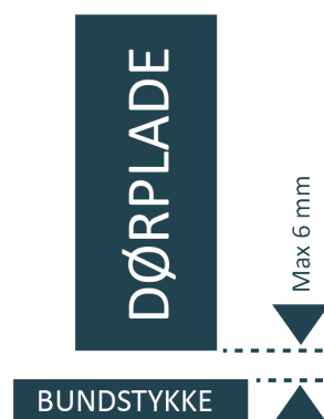
Fig. 2: Nederst er bundstykket illustreret. Ovenfor ses dørplade. Afstanden herimellem må max være 6 mm.
